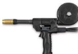
Pistola de aluminio portátil para aplicaciones industriales, cable 30 pies, cuenta con portacarrete integrado, gira 180 grados, gatillo de 2 etapas con válvula de gas integrada, se puede ajustar la velocidad de alimentación en el mango de la antorcha, rodillos reversibles, puntas de contacto con cambio rápido de una vuelta
