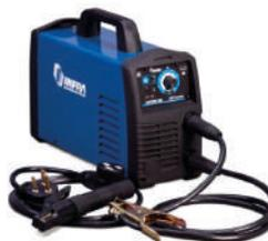
Configuración automática de tensión de alimentación , suelda con electrodos de 1/16" a 3/16" en electrodos E7018, 6013, 6011 e inoxidable. (Excepto aluminio)
