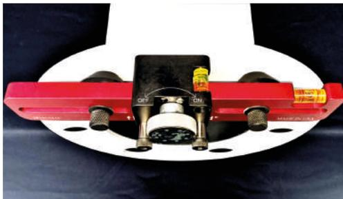
El nivelador de bridas magnético trabaja en orificios de brida de 1/2" hasta 1-15/16" de diámetro y se alinea horizontal y verticalmente en la cara de acero de la brida.
