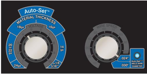
Auto-Set elimina las conjeturas y permite ahorrar tiempo en la configuración. Gire el control de la velocidad del alambre por completo en el sentido de las agujas del reloj para seleccionar el modo Auto-Set y establezca el diámetro del alambre en 0,024 o 0,030 pulgadas. La luz de Auto-Set indicará que se activó ese modo. A continuación, seleccione el espesor del material con el control Auto-Set.
