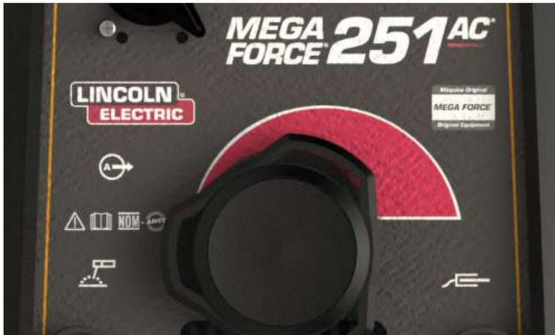
Ajuste preciso de corriente debido a su mecanismo de ajuste fino.
