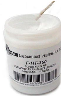
**Descripción:** Fundente para usos múltiples, baja temperatura, para soldar aleaciones de plata, metales ferrosos y no ferrosos tales como cobre, bronce, latón aceros y aceros inoxidable. Rango de temperatura: 1050°F/ 566°C – 1600°F/871°C )
