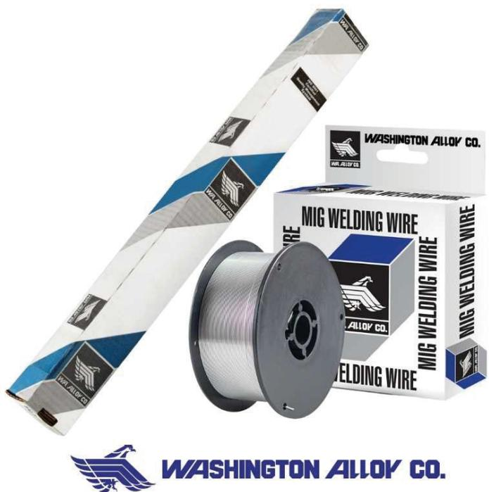
Aporte de aluminio de silicón al 5%, usualmente utilizadas en las aplicaciones de soldadura de aluminio, Para aplicaciones en material base e 3003, 3004, 5052, 6061, 6063 y las aleaciones de fundido 43, 355, 356 y 214. Cuenta con un rango de fusión de de 1065 a 1170°F y una densidad de .097 lbs. por pulgada cúbica. Su color después de anodizado es gris. El ER4043 tiene una fuerza típica de tensión de 29,000 libras por pulgada cuadrada. Disponible para procesos de soldadura MIG, TIG.
